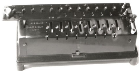
Beispiel 3: TIM Modell II / S/N6888 mit Eingabeanzeige links neben dem Schieber
