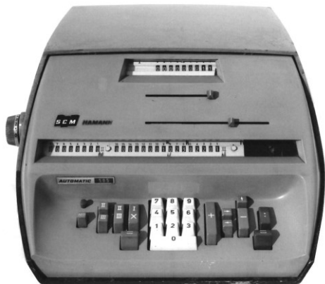
Beispiel 4: Hamann-SCM Modell 505 mit Zehner-Blocktastatur, S/N 503178.
