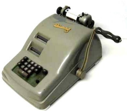
Beispiel 2: Rheinmetall Modell AHS mit Eingabe- anzeige oberhalb der Zehnertastatur
