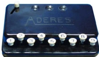
Beispiel 3: Aderes von 1949 mit zweireihiger Tastenanordnung
