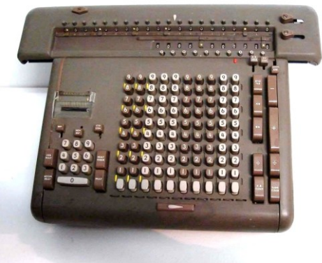
Beispiel 3: Friden Modell STW 10 von 1950, Eingabekapazität des Multiplikators 10-stellig,
