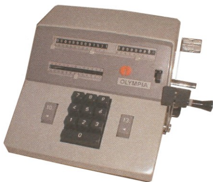
Beispiel 2 Olympia Modell RT 4 mit Zehner-Blocktastatur
