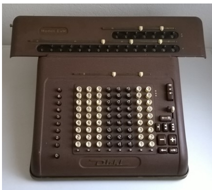
Beispiel 4: : Diehl Modell EvM 15 mit einer Multiplikatorwahltastatur auf der linken Bedienfeldseite.
