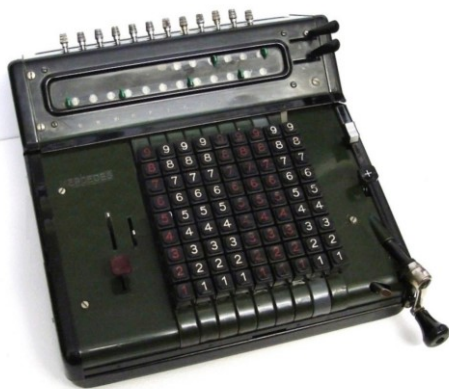
Beispiel: Mercedes-Euklid Modell 29 mit Handantrieb, S/N101970.
