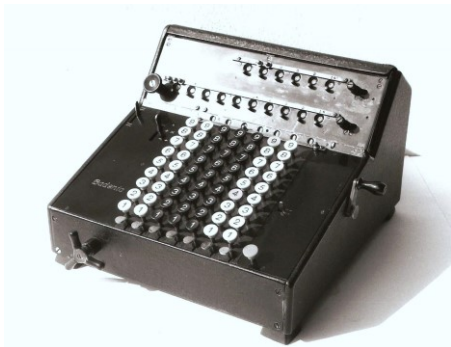
Beispiel 1: Badenia Modell TEH 10 mit Eingabe- anzeige oberhalb der Volltastatur
