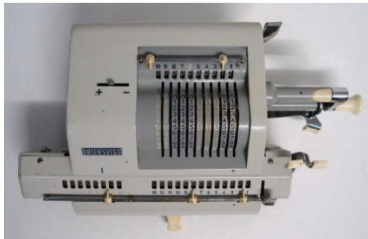
Beispiel Variante V: Brunsviga 13 RM für Einhandbedienung; mit nebeneinander liegenden Löschhebeln des Rechenschlittens auf der rechten Seite.
