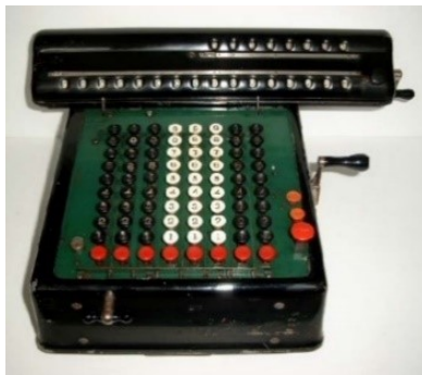
Beispiel 1 Variante II: Monroe K (Handantrieb) mit einer Einzellöschtaste (rot) unterhalb jeder Tastenreihe.
