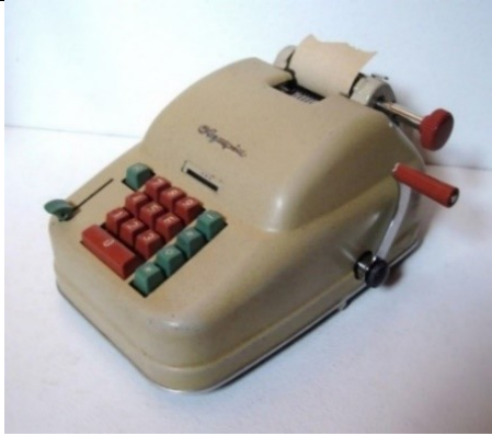
Beispiel Variante I: Olympia 1182-030 (Handantrieb) mit Handhebel für das manuelle Löschen aller Funktionstasten, des Stiftschlittens-Inhaltes und der Stellenanzeige.
