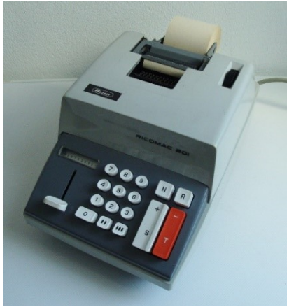
Beispiel 1 Variante II: Ricoh Ricomac 201 (Elektroantrieb) mit Schieber für das gemeinsame manuelle Löschen des Stiftschlittens und der Stellenanzeige.
