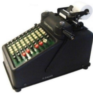
Beispiel Variante I: Wanderer Continental 8 (Handantrieb) mit Gesamtlöschtaste „C“
