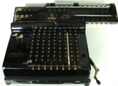
Beispiel 3 Variante I: Record Universal (1925), Löschiene manuell.
