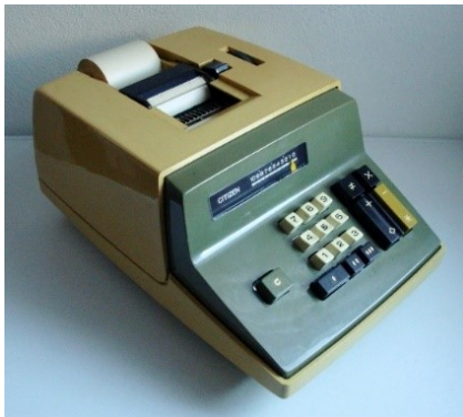
Beispiel 2 Variante II: Citizen CA-10 mit Korrektur-Taste für das gemeinsame maschinelle Löschen des Stiftschlittens und der Eingabeanzeige.
