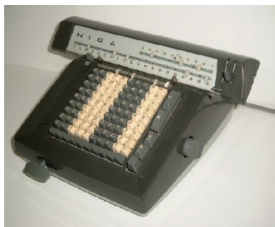
Beispiel 2 Variante II: Nisa PK 5 (Elektroantrieb) mit Einzel- und Gesamtlöschung der Tastenreihen.
