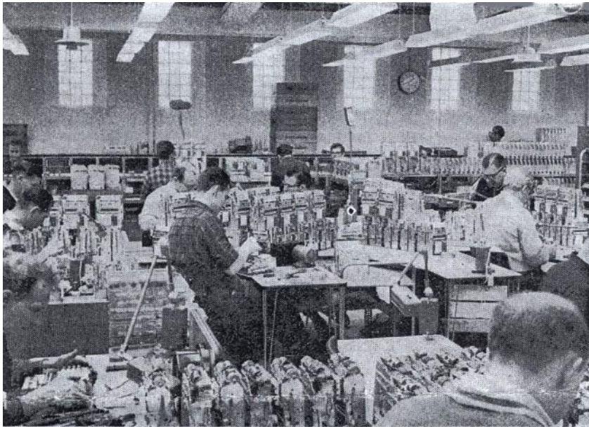
Et hjørne af samlesalen, og i forgrunden et parti CONTEX 20. Den lille cylinder bag det store hvide nylontandhjul på disse maskiner er den specialkonstruerede tyske motor.
