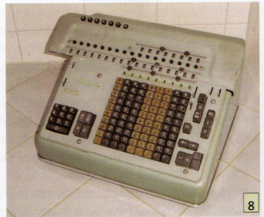
Bild 8 SAR II c, die Multiplikation erfolgt jetzt auf der linken Seite, mit RÜ
